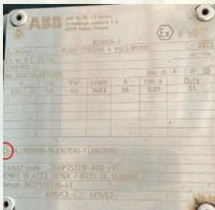
Gambar 45 Nameplate Pompa dengan IE Rating 3 di BPG
