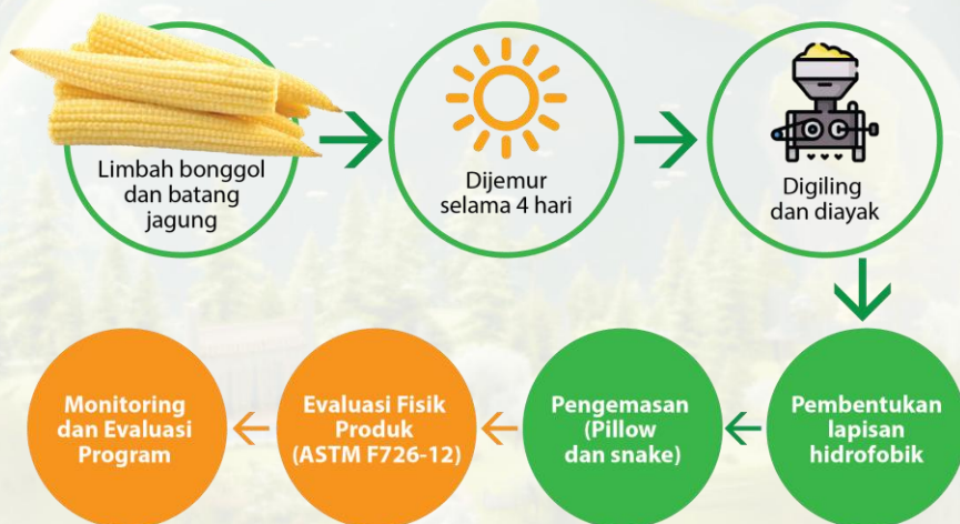
Gambar 2 Skema Pembuatan Oil Absorben dari Limbah Bonggol dan Batang Jagung
