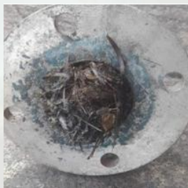
Gambar 36 Kontaminan Padat yang Menyumbbat Saluran Suction Mobil SCC
