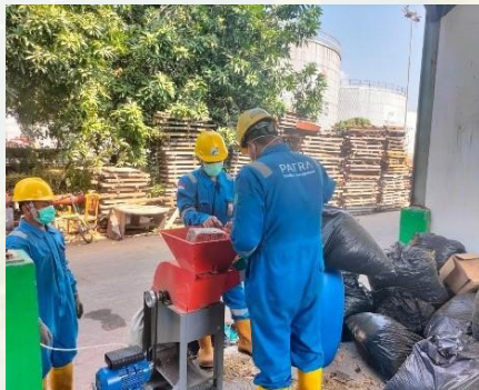
Gambar 48 Proses Penggilingan Sampah Organik di BPG
