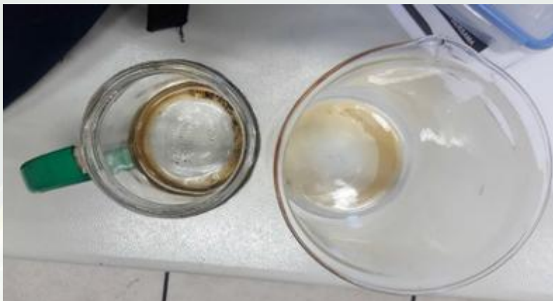
Gambar 28 Kondisi Bahan Bakar Sebelum dan Setelah Dipasang Sistem Filtrasi
