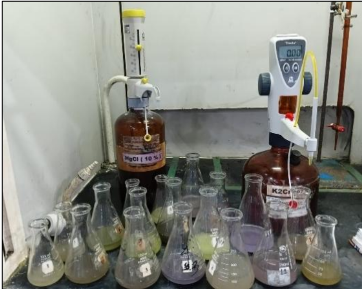
Gambar 17 Proses Analisis Kadar Fe dalam Sampel Backlog
