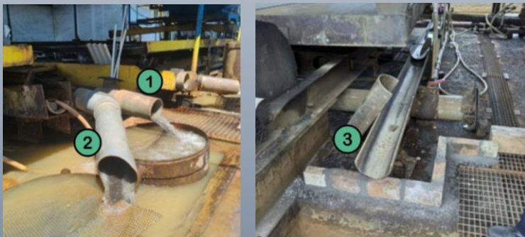
Gambar 22 Output 1 (Konsetrat Timah) ; output 2 (MIT) ; Output 3 (sisa pasir menuju arah lain)
