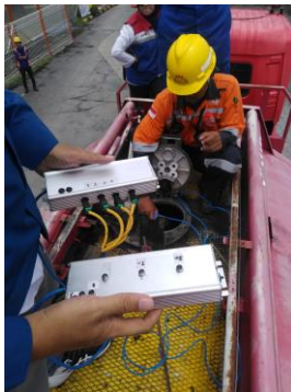
Pengecekan Tinggi Cairan di Mobil Tangki dengan Sensor
