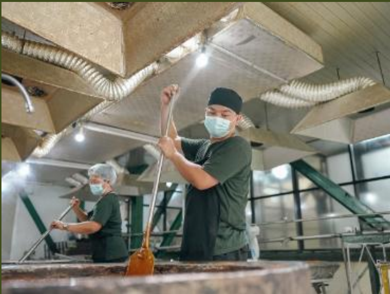
Proses Pengolahan Aren Menggunakan Direct Use Panas Bumi
