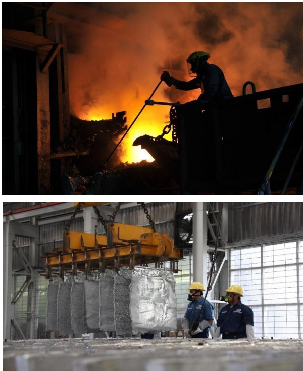
Gambar Proses Pengolahan dan Peleburan Bijih Timah
