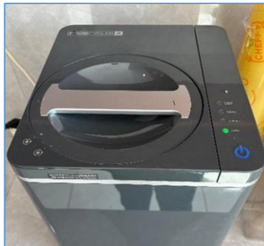
Gambar 5. 3 Alat Food Composting yang digunakan untuk proses kompos sisa makanan
