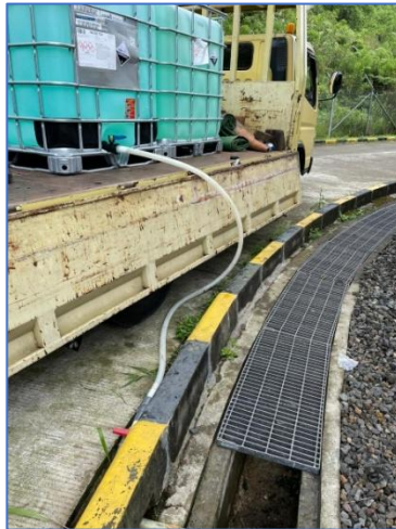
Gambar 4. 7 Limbah bekas kemasan bahan kimia Biocide (N7330 dan N73831) dengan volume 28 jeriken/bulan Proses pengisian biocide dari vendor NALCO ke tanki penampungan SDOCTOR berukuran 2 x 1000 liter secara gravitasi
