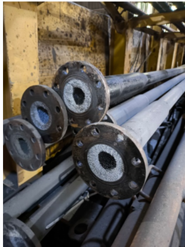
Pipa C Lance dengan tambahan Ceramic Paste (Setelah Program)
