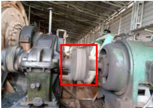
**Gambar 1. Limbah Ban Bekas yang Dimanfaatkan sebagai Substitusi Karet Pembalut Baut Pada *Joint couple* Mesin *Ball Mill***
