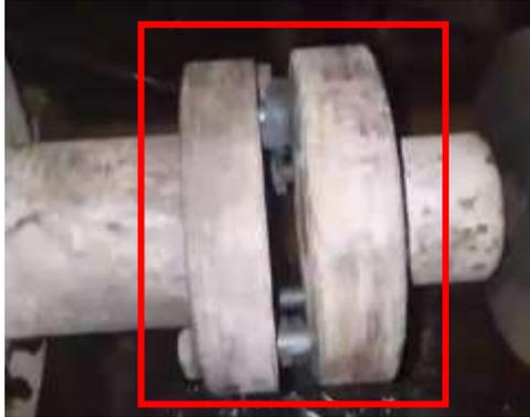
**Gambar 2. Dokumentasi Limbah Ban Bekas yang Dimanfaatkan sebagai Substitusi Karet Pembalut Baut Pada *Joint couple* Mesin Pompa Air**
