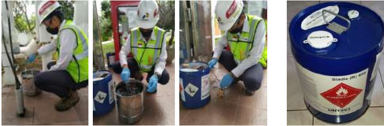
Gambar. Proses Penambahan Stadis secara Manual
