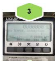
3 Refueler bisa di-start dan meter register siap dioperasikan
