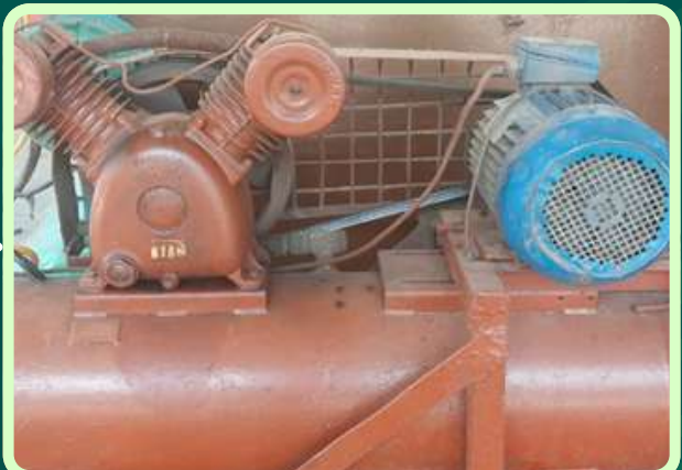
Pemompaan angin ban alat berat menggunakan compressor listrik
