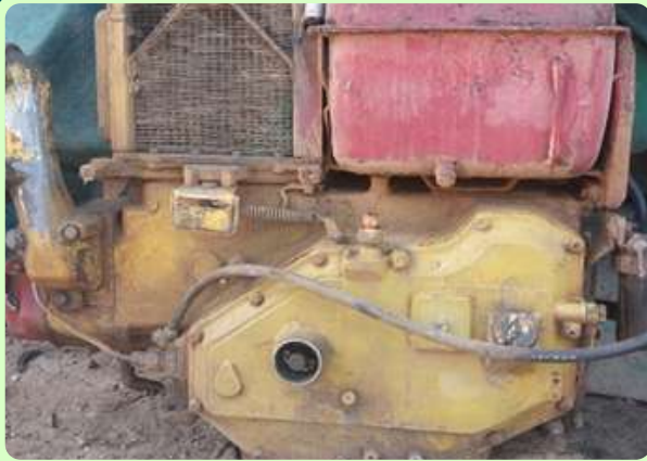
Pemompaan angin ban alat berat menggunakan compressor solar
