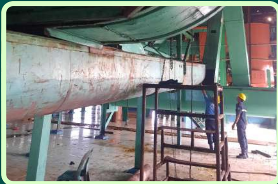
Jalur Penyaluran Berondolan Menuju Pressing
