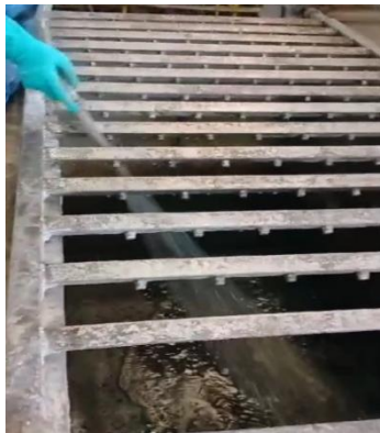
Gambar 17 Air Bekas pencucian anoda sebagai larutan elektrolit kembali
