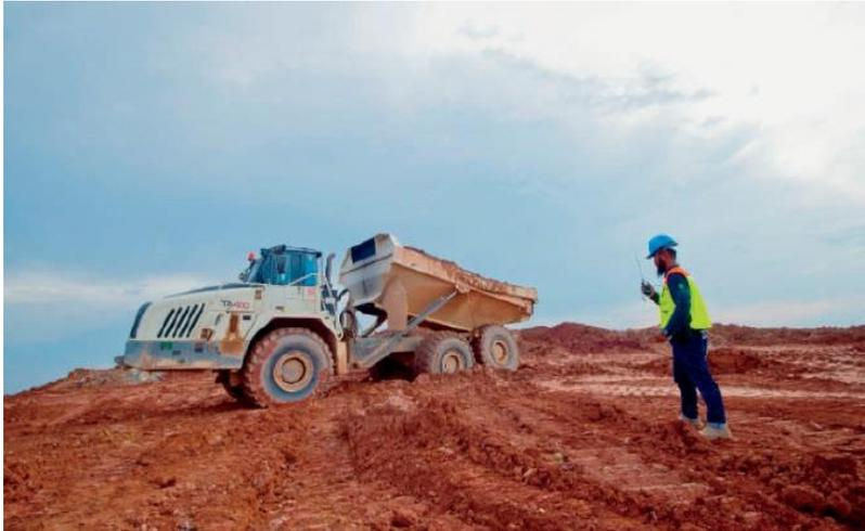
**Gambar Kegiatan *Rehandling* pada Penambangan Darat**
