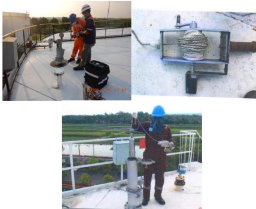
Gambar 4.2 Modifikasi Alat Pengambilan Sampel BBM di Tangki Timbun
