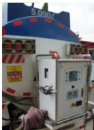
Gambar 1.6 Pemasangan Transportable Dispensing & Digitalized Flowmetere ke Mobil Tangki PTO
