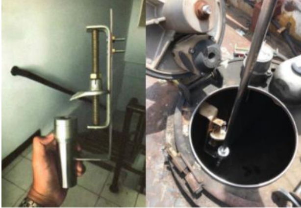
Gambar 4.4 Pemasangan Alat Pasteng Di Ijkbout Tangki BBM Pada Mobil Tangki
