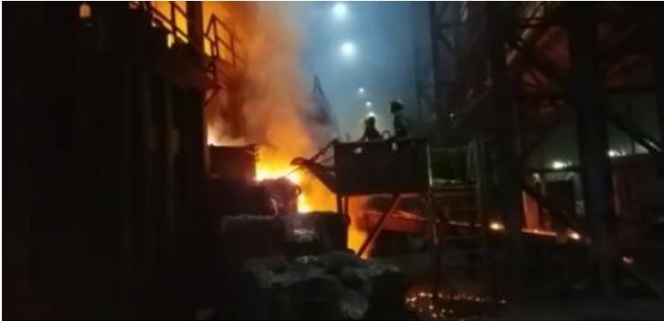
Saat ini untuk proses peleburan timah PT TIMAH Tbk Unit Produksi Kunder menggunakan tanur tetap (stationary reverberatory furnace).
